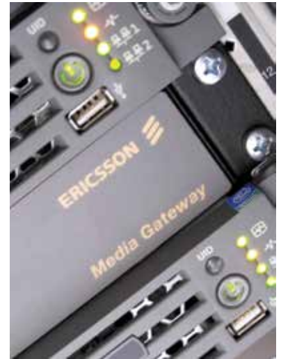
Media Gateway, uređaj koji je povezivao IMS mreže s tradicionalnim mobilnim i fiksnim mrežama, 2005. godina
